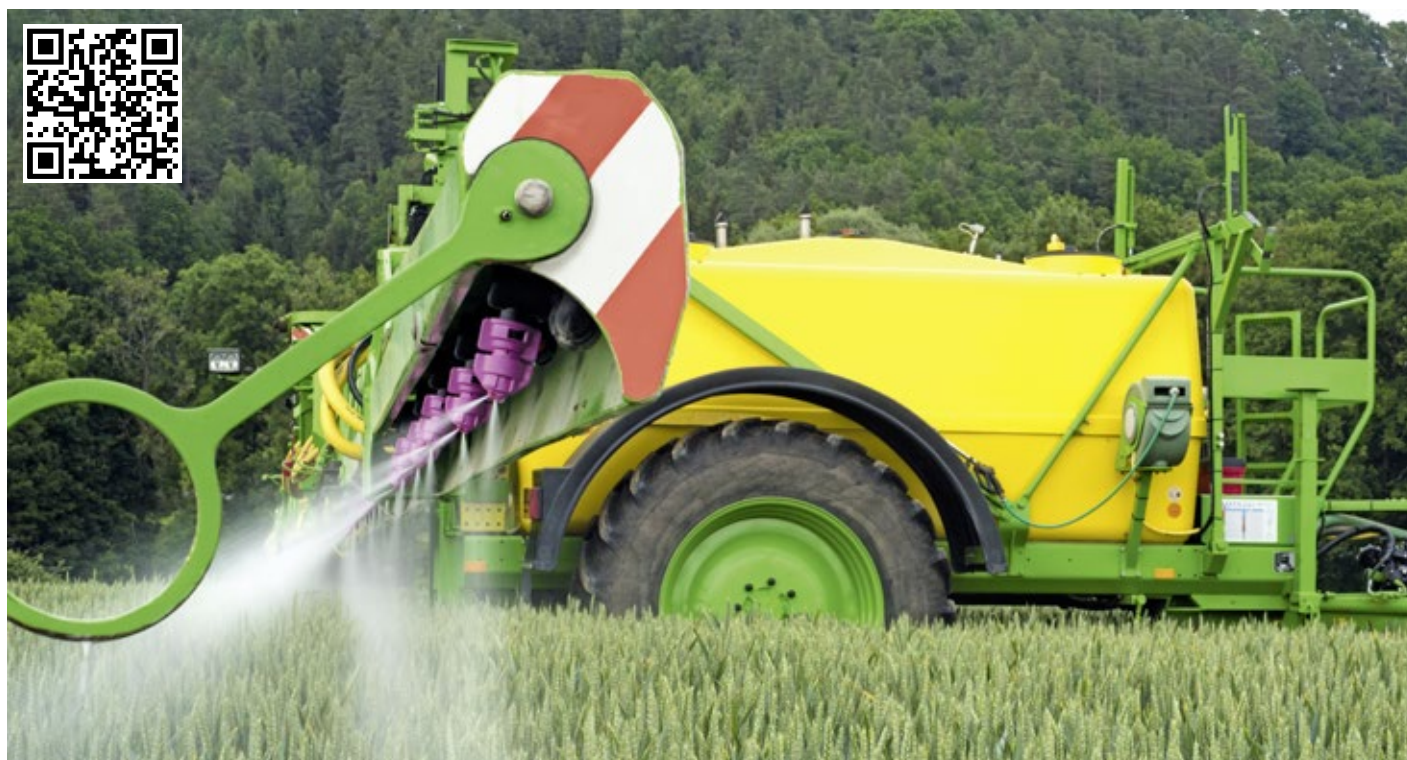
TD HiSpeed 110-025 v provozu – nestříká na konstrukci postřikovače – 10° úhel výstřiku dopředu
